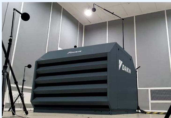
Medición del nivel de potencia sonora medido en una cámara anecoica
